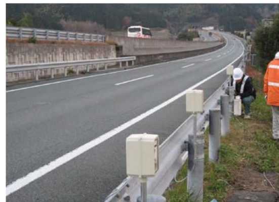
図-5 可搬式トラフィックカウンターによる交通量調査
