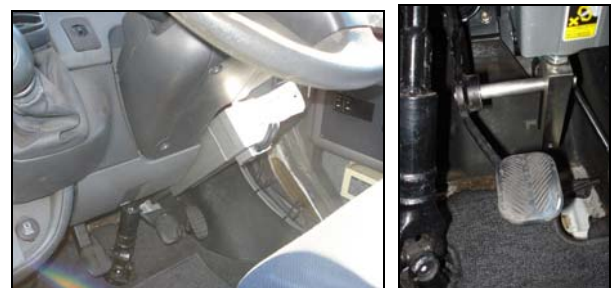
図-5 次位車のブレーキペダル自動操作機構
