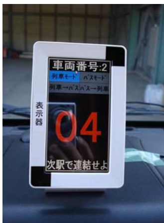
図-8 試作した運転士指示表示器
