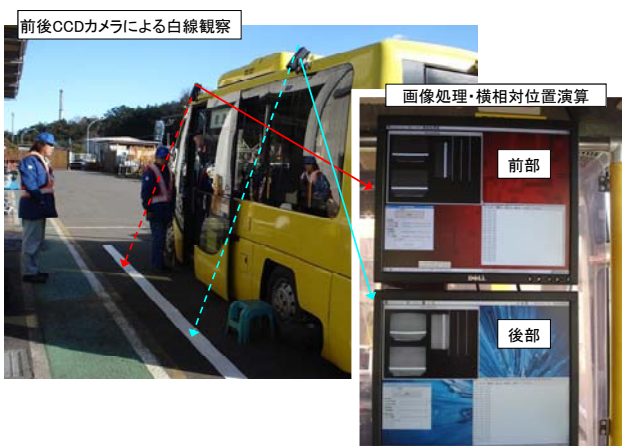
図-3 光学式非接触車両誘導システムの機能確認
