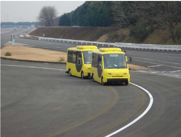
図-10 連結・曲線走行試験中の試験車両
