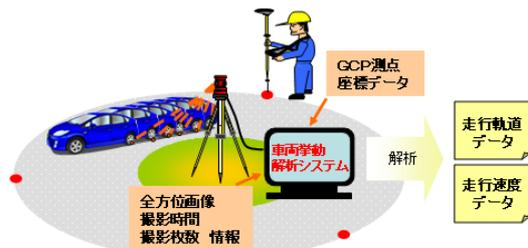
図-2 車両挙動解析システムの全体イメージ
