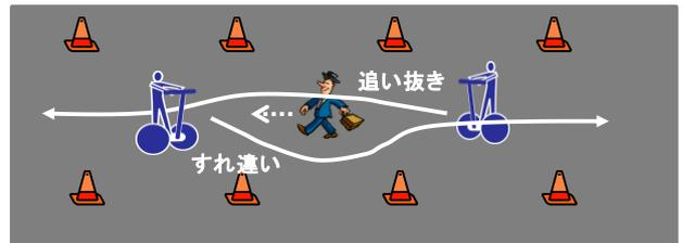
図-4 追い抜き・すれ違い走行実験のイメージ
