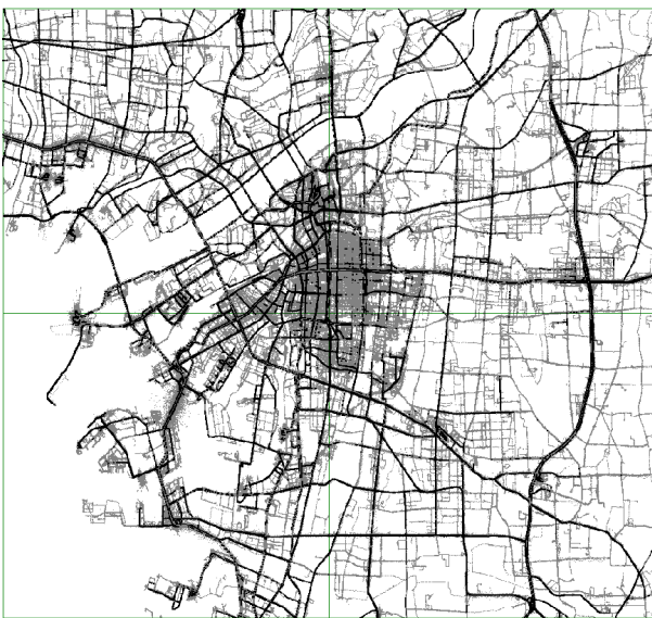
図9 道路の2階層モデル化の例 黒：高頻度道路 灰：低頻度道路
