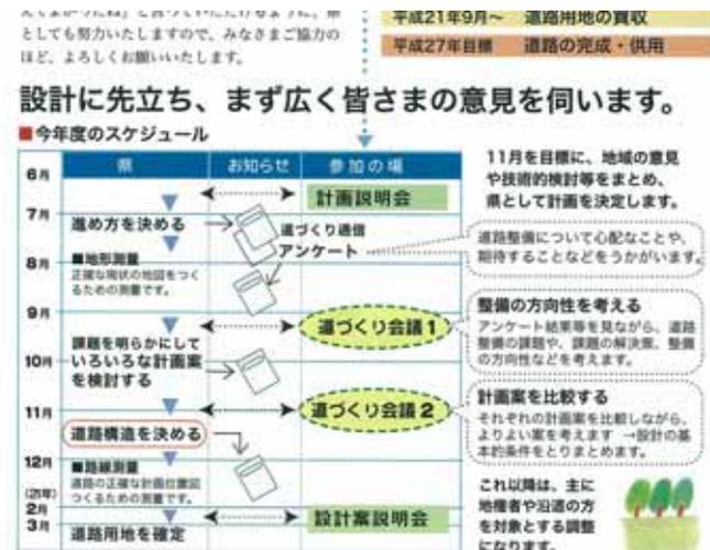
図-4 道路設計段階のプロセスとPIの進め方(当初)<sup>2)</sup>
