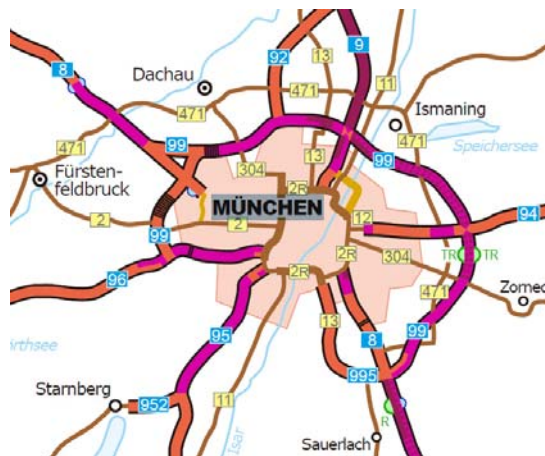
図-2 Muenchen 付近 13) ：図左上から A8 を南東進し、環状 A99 を反時計回りに走行し、A96 を西進する場合の問題点。A8 から A99 東進分岐と A99 西進分岐の箇所が大きく隔たっている。
