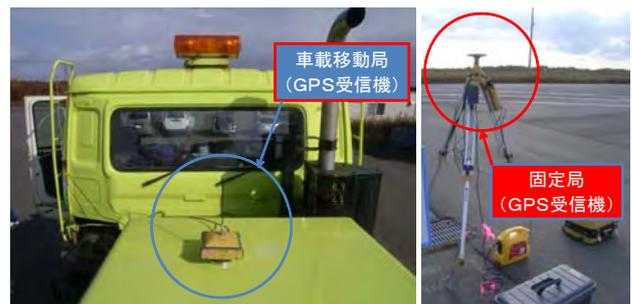
写真-2 GPS計測器取付け状況（除雪トラック）
