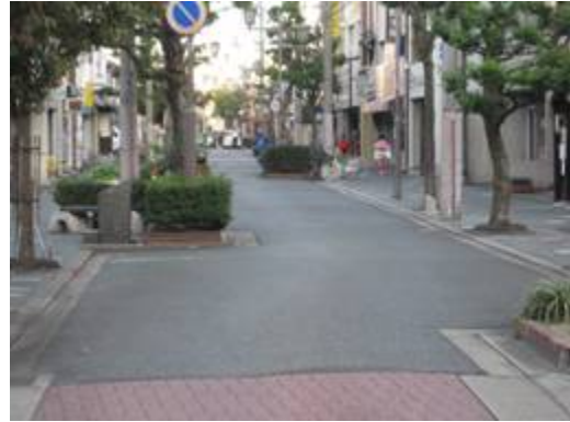
写真2 速度抑制効果が高いと考えられるシケイン形状
