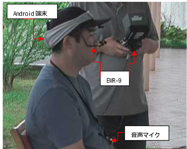
図 - 3 視線挙動実験での端末装着状態 (予備実験時)
