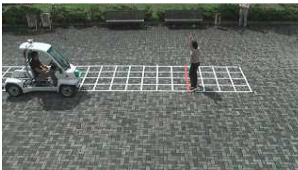
図 - 2 緊張・危険回避行動実験状況 (予備実験時)
