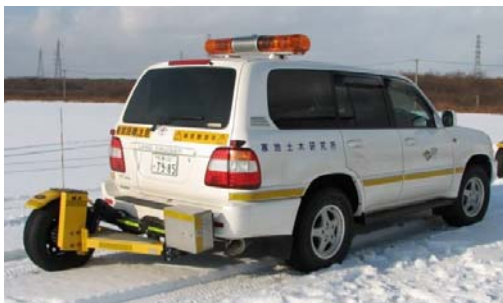
図3 連続路面すべり抵抗値測定装置 (CFT)
