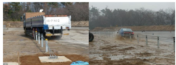
写真-8 衝突時の状況（左：大型車、右：乗用車）
