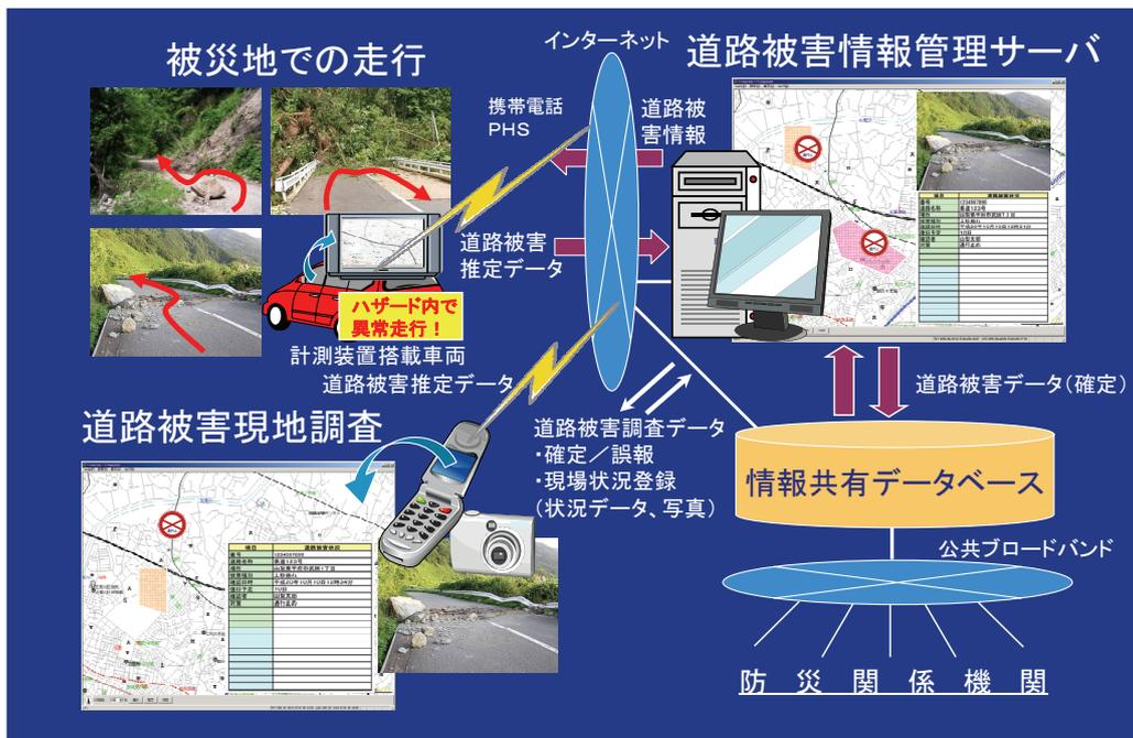
図-1 道路被害情報管理システムの概念図
