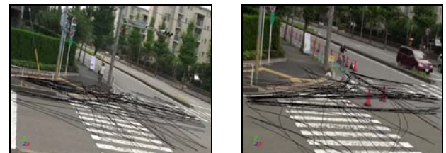
図-5 自転車道設置前（左）と設置後（右）の軌跡
