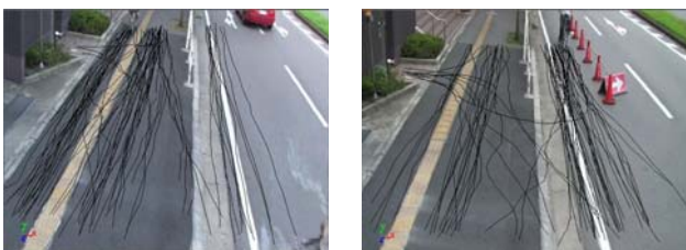
図-3 自転車道設置前（左）と設置後（右）の軌跡
