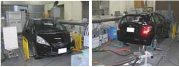
写真 - 1 ジャグ付メータによる乗用車 (FF) の燃費測定
