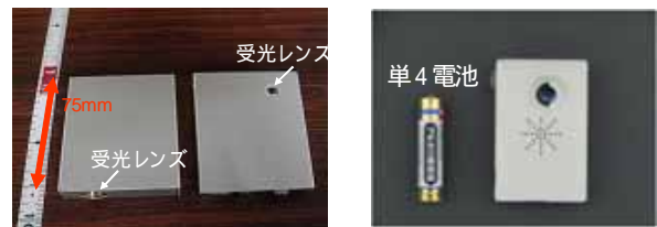
図-2 調査に使用する旧型受光器(左)と新型受光器(右)
