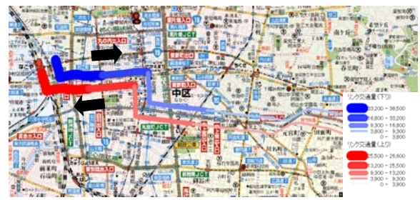
図-5 LRT 電停間利用者数(Case_広小路通ゾーン制)
