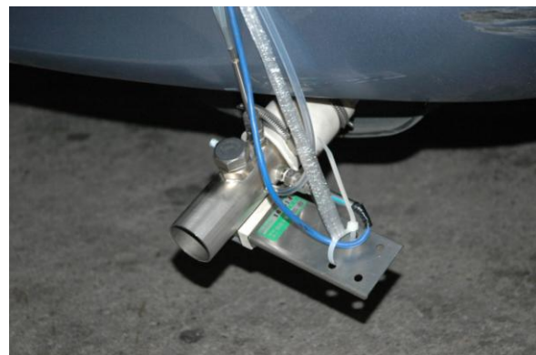
写真-2 CO 2 吸引管・ピトー管の取り付け状況
