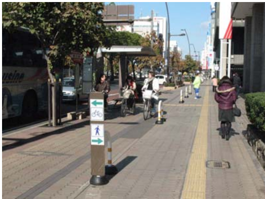
図-2 社会実験中の状況（分離柵・案内板設置）
