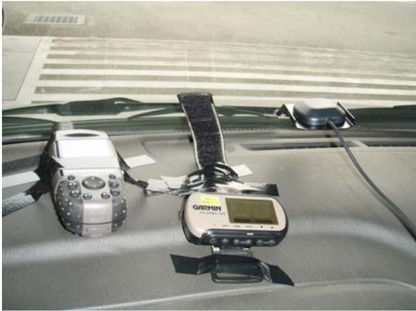
図3 救急車両へのGPSの設置
