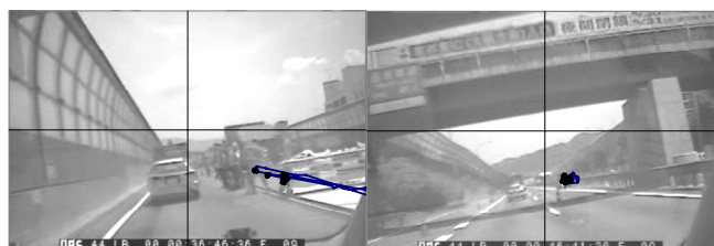
図-6 視線軌跡図(左:工事A, 右:空規制②)
