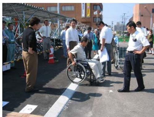
図－1 歩道の段差試験
