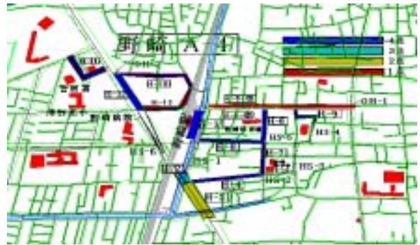
図 - 3 野崎地区における舗装の評価
