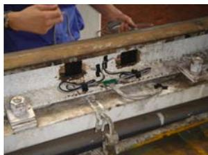
図4 ひずみゲージ
