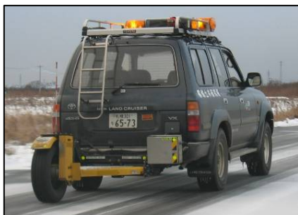
写真1 連続路面すべり抵抗値測定装置
