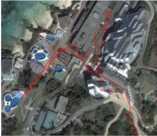
図-2 測位ログデータの例 (取得間隔5秒)
