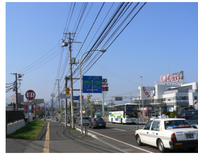
写真-9 車道寄りの電柱占用
