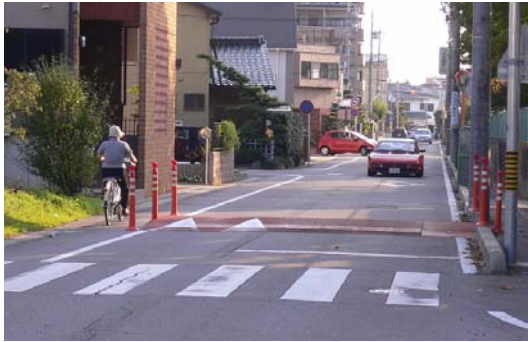
図2 ポストコーンの設置状況
