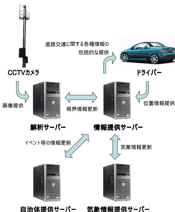
図6 RWML 技術を利用したシステムの概略
