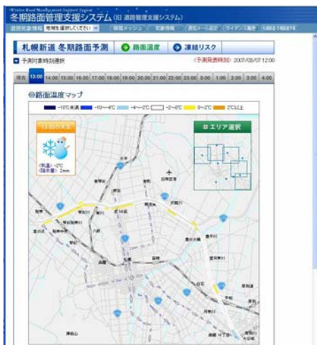
図-2 線的路面温度分布(路面温度マップ)
