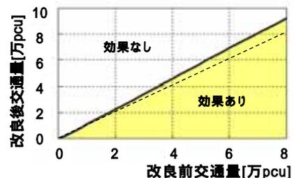
図-7 交差点改良前後の自動車交通量の変化と削減効果の有無
