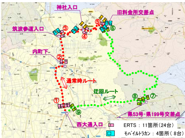
図-3 調査機器設置箇所
