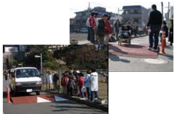
図 6 仮設ハンプ実験の様子
