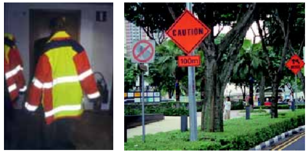
写真-2 安全ベスト（左:スウェーデン 3) ）とオレンジ系高輝度標識（右、シンガポール 4) ）
