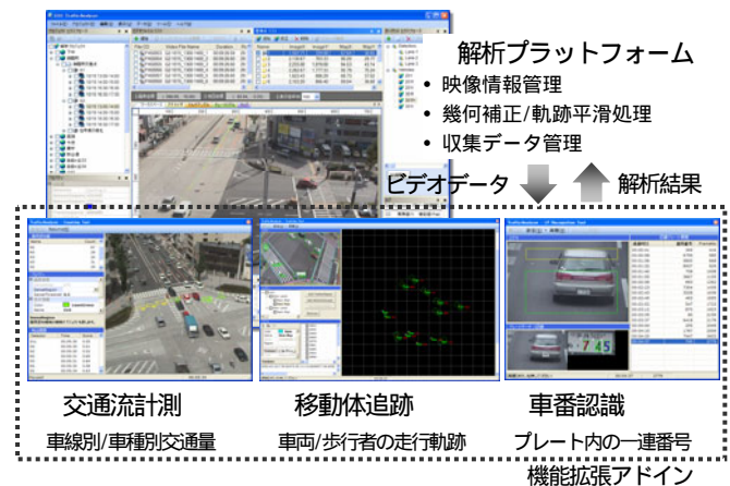
図-1 ビデオ画像処理システム TrafficAnalyzer の構成 1)
