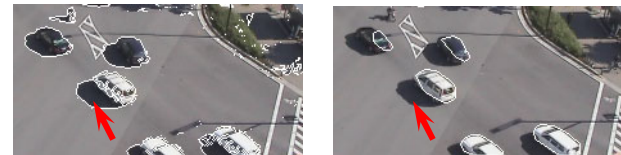
(a) 車両周辺に生じる影 (b) 影部分の除去 図-5 車両周辺に生じる影の除去
