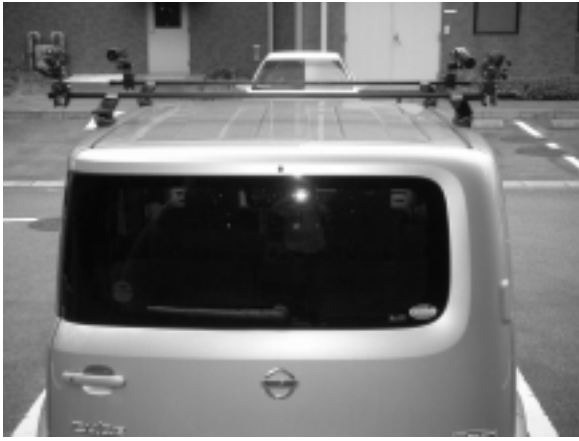
写真-1 コンフリクト観測装置を搭載した車両
