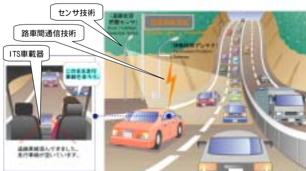
図 - 5 ITS 技術を活用したサグ部渋滞対策のイメージ (AHS-i) (車線利用率適正化サービスの場合)
