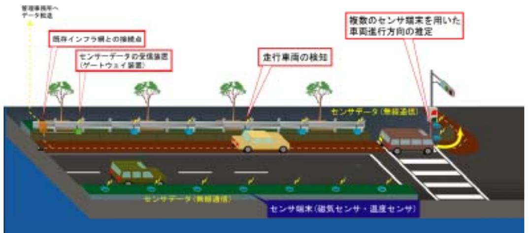
図8 道路交通調査へのセンサネットワーク利用イメージ
