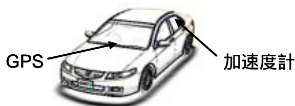
図-2 構築したプローブカー
