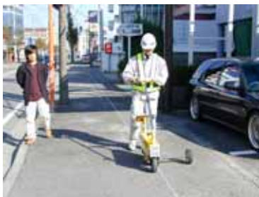
写真 - 4 DAMによる路面計測
