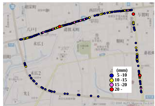
図 - 7 プローブ自転車により計測した加速度から推定した段差の分布
