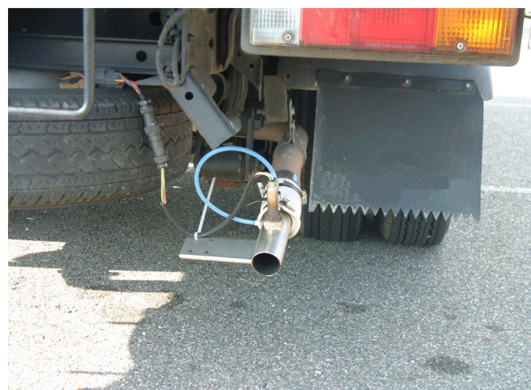
写真-1 NO x センサ取付状況
