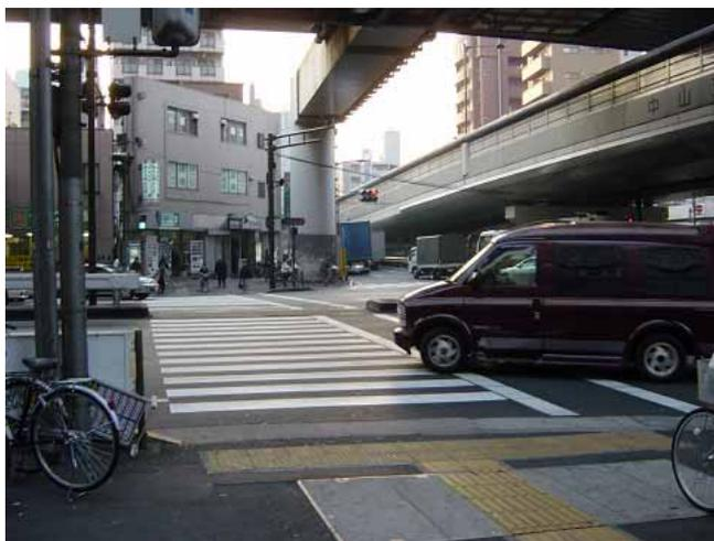
写真 - 1 分離横断歩道信号青時に左折車が通過す例
