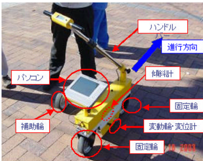
図1 路面形状計測装置(DAM)
