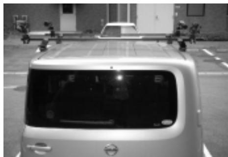
図 2 コンフリクト観測装置を搭載した車両
