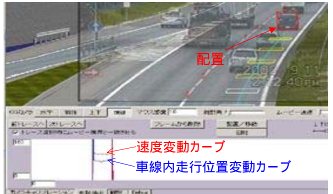
図-4 対象車両の軌跡計測状況
