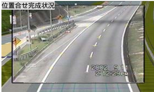
図-2 3D 道路モデルとビデオ映像の位置合せ
