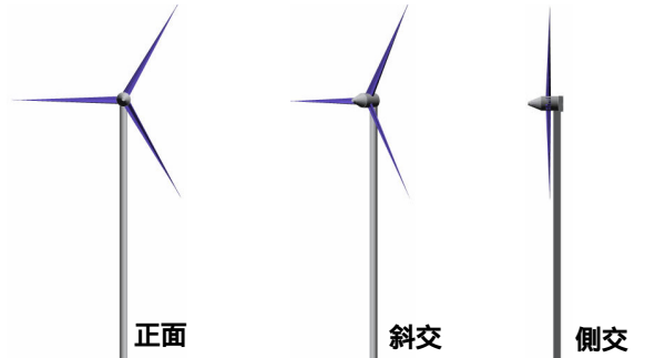
図 4 プロペラ型風車の視軸方向による景観変化
