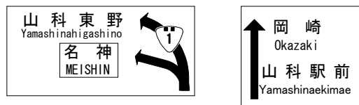
図 - 1 対策前の標識(車線ごとの表示)
