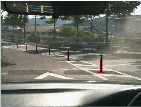
図3 ビデオ実映像にポストコーンを合成した例
