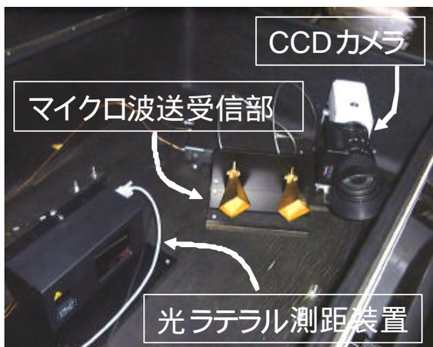
図5 隣接車線側方車両計測用機器類
