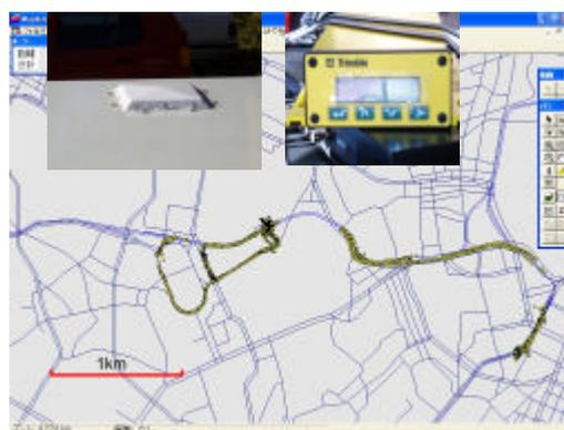
図3 GPS装置と車両軌跡プロット
